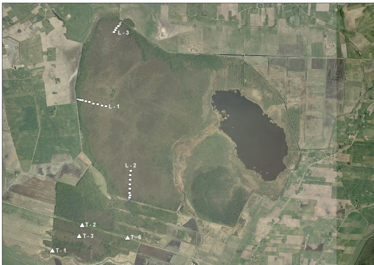
Pav. Amalvos pelkės vandens lygio stebėjimo transektų išdėstymo schema 2018 m.
